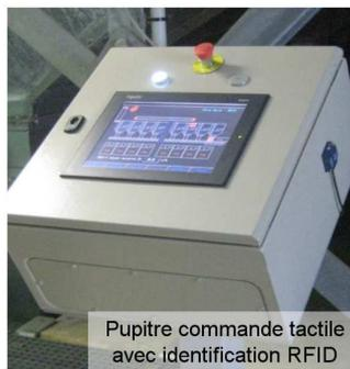
Pupitre commande tactile avec identification RFID
